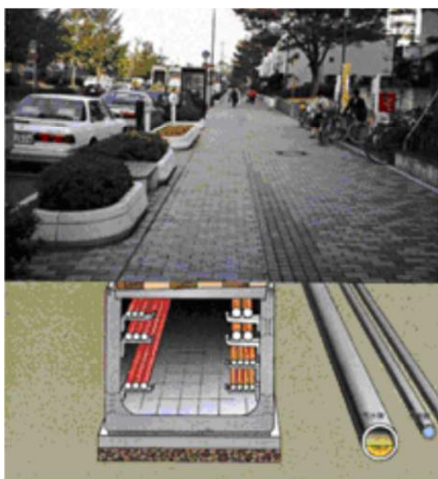
Strada infrastrutturata con cunicolo tecnologico
